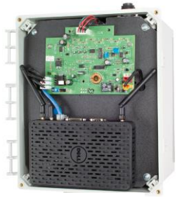
PECU (Portable Edge Computing Unit)
